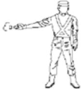
Braço estendido horizontalmente, agitando uma luz vermelha para um determinado veículo.
